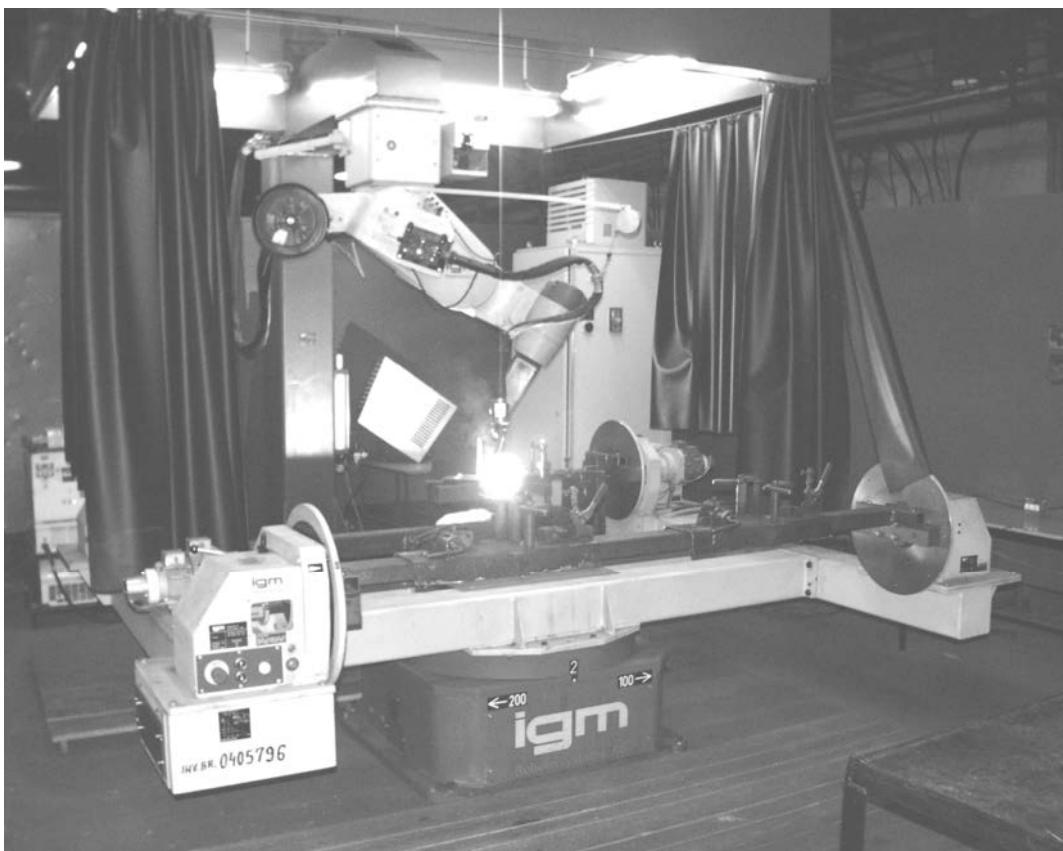
ROBOTSKA STANICA ZA ZAVARIVANJE IZRADAKA
